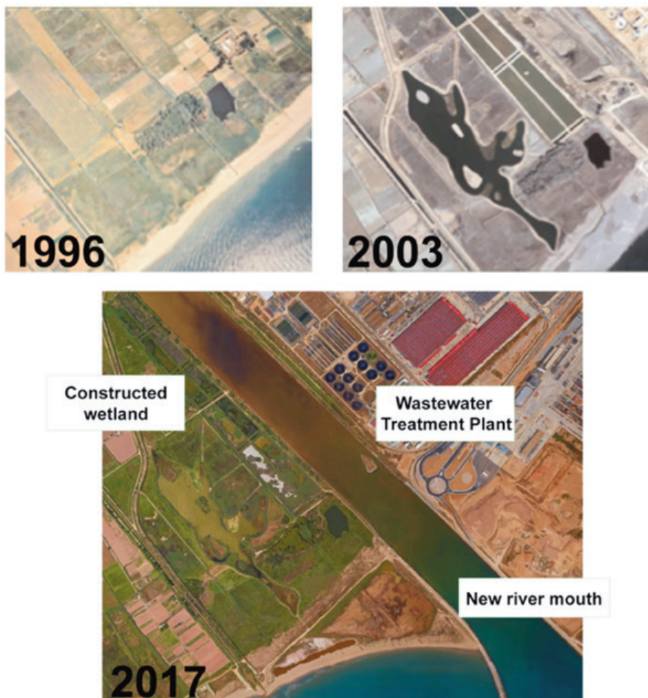
Figura 1: foto de la zona d'estudi en els anys 1996 (abans de la construcció de la llacuna de Cal Tet, a dalt a l'esquerra), 2003 (quan es va acabar la construcció de la llacuna i abans que s'excaués la nova desembocadura del riu Llobregat, a dalt a la dreta) i en l'actualitat (a baix). A la fotografia actual s'han marcat l'estació d'aigües residuals del Baix Llobregat, la nova desembocadura del riu Llobregat i els canyissars de depuració que rebien l'efluent del tractament terciari de la depuradora. Font de les fotografies: Google Earth.
