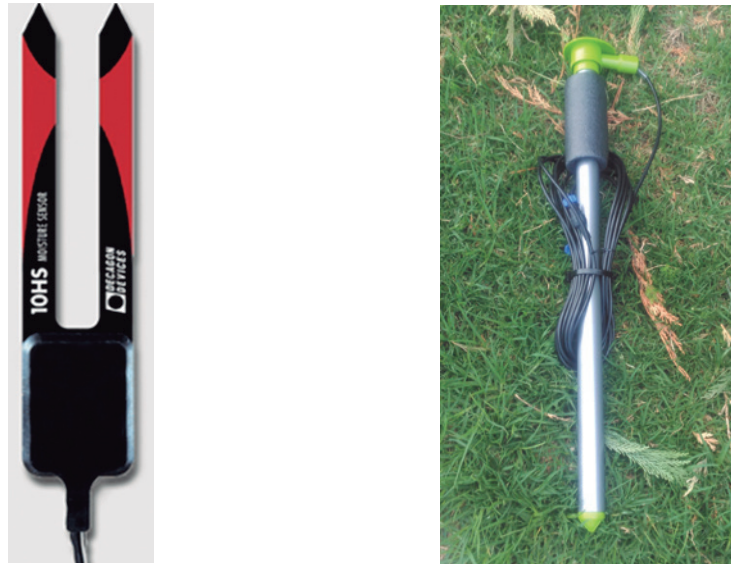
Figura 11.- Tipologia d'alguns sensors de capacitància emprats en les mesures de contingut hídric del sòl (Aquacheck i 10HS0).
