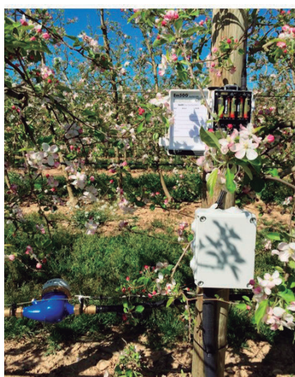
Figura 10.- Model del punt de control de l'estat hídric en una parcel·la de fruiters. Consta de tres sensors de mesura de contingut volumètric d'aigua col·locats un sota l'altre a 20, 40 i 60 cm de fondària, un comptador volumètric digital de l'aigua de reg de la línia de degoters i un datalogger-transmissió de la informació.
